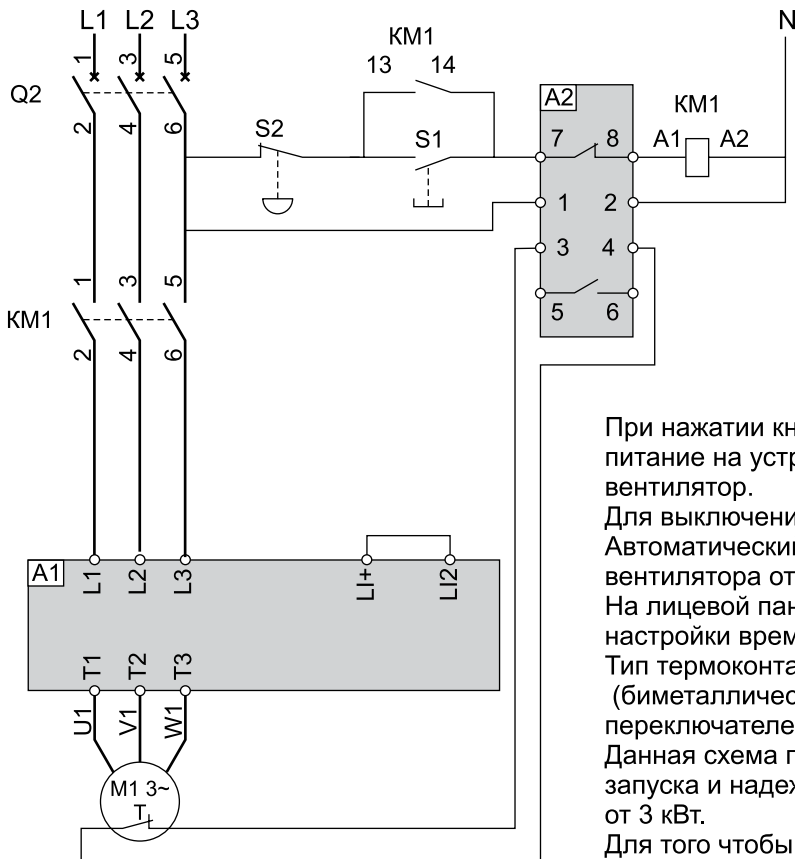
Схема подключения, двигатель вентилятора оснащен термоконтактами
